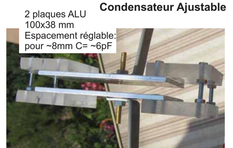
(Attention, des vis « NYLON » entre les plaques d'alu fondent avec 60W HF dans l'antenne !!!
